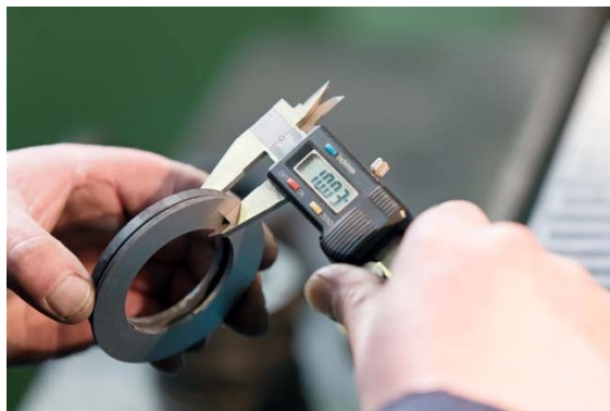
Figur 3. Opmåling af et emne med en digital skydelære.
