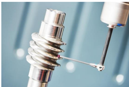
Figur 13. Udførelse af meget præcis og nøjagtig måling med en koordinatmålemaskine.
